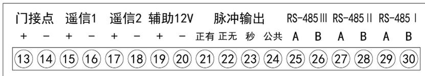
图 6 终端弱电接线端子示意图
